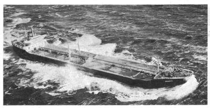
Zwischen Japan und der amerikanischen Westküste verkehren zwei schnelle Container-Schiffe, welche mit Sulzer-Motoren japanischer Lizenz vom Typ 8RND105 (je 32000 PS Leistung) ausgerüstet sind. An der Probefahrt erreichte das abgebildete Schiff «Japan Ace» eine Geschwindigkeit von 26,2 Knoten.
