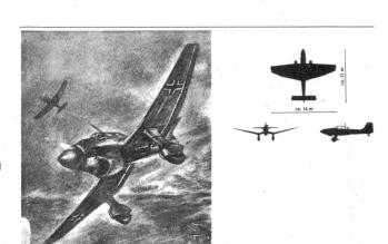
Deutscher Sturzkampfflieger Junkers Ju 87, «Stuka» genannt. Besatzung 2 Mann, Bewaffnung 2 Mg starr, 1 Mg beweglich, Bombenlast maximal 600 kg. Bombenarten: 50, 250 und 500 kg Sprengbomben. Gipfelhöhe 7400 m. Aktionsradius 600 km, Höchstgeschwindigkeit 340 km/h, Reisegeschwindig-keit 280 km/h, Besonderes: Lärmvorrichtung um den Gegner beim Sturzangriff mit Sirenengeheul zusätzlich zu belasten. Sirene im Soldatenmund «Jericho-Trompete» genannt
