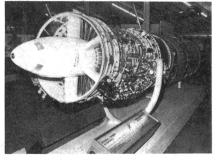
Die an der Luft- und Raumfahrtausstellung in Vaduz zur Schau gestellte ATAR-Strahlturbine 09 C, die von der Firma Gebrüder Sulzer AG in Lizenz hergestellt und in die Mirage-III-Flugzeuge unserer Flugwaffe eingebaut wird. Die ATAR-Strahlturbine ist französischen Ursprungs und stammt von der Firmengruppe SNECMA, die Flugtriebwerke und anderes Luftfahrtgerät herstellt.
