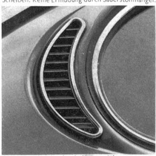
Die neuen Luftschlitz für die Absaugentlüftung.
