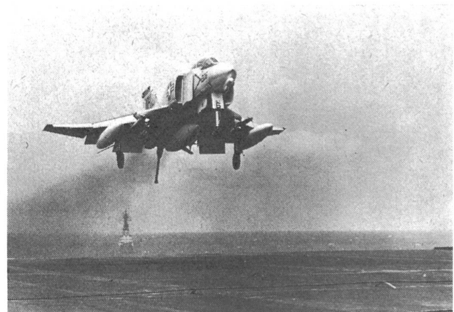
Ein F-4 B Phantom der Abfangjägerstaffel 114 kehrt nach einem Einsatz auf den Träger «USS Kitty Hawk» zurück. Beachte den Fanghaken und die Bremsseile im Vordergrund. Im Hintergrund der wachhabende Zerstörer.
