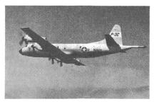
Mit geballter Kraft (vier Propellerturbinen von je 4590 WPS) kurvt Orion wie eine hungrige Möwe über dem Wasserspiegel, um zu Nahrung zu kommen. An Bord lagern atomare und gewöhnliche Wasserbomben, Torpedos, Rakaten und Minen. Die Normalbesatzung beträgt 10 bis 12 Mann, wovon 5 Mann Flugpersonal und 7 Mann für die Bedienung der Elektronik.
