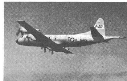
Mit geballter Kraft (vier Propellerturbinen von je 4590 WPS) kurvt Orion wie eine hungrige Möve über dem Wasserspiegel, um zu Nahrung zu kommen. An Bord lagern atomare und gewöhnliche Wasserbomben, Torpedos, Raketen und Minen. Die Normalbesatzung beträgt 10 bis 12 Mann, von 5 Mann Flugpersonal und 7 Mann für die Bedienung der Elektronik.
