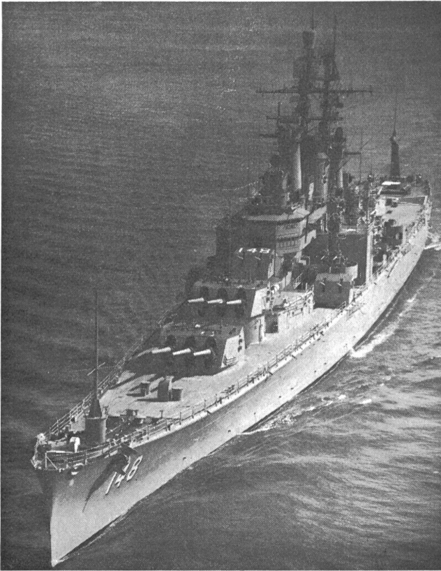
Das Flaggschiff der 2. Flotte, der schwere Kreuzer «USS Newport News», 21 000 Tonnen schwer, 1300 Offiziere und Mannschaften an Bord, 60 km/h Höchstgeschwindigkeit, 1949 in Dienst gestellt, 120 000 PS. Drei Dreiertürme mit 20,3-cm-Rohren, zwölf 12,7-cm-Rohre, vier 7,6-cm-Rohre und zwei «Zuni»-Anti-Raketen-Raketen bilden die Bewaffnung des Schiffes. Tägliche Destillation von ca. 270 000 Litern Wasser. Absolvierte eine achtmonatige Vietnamtour.
