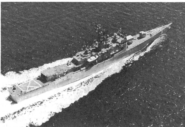
Raketengeleiter sind die neuesten Erzeugnisse des amerikanischen Kriegsschiffbaues. Diese relativ leichten Schiffe (nur 3426 Tonnen) sind mit einer unerhört starken Bewaffnung versehen und sehr wendig. Eine Flakkanone 12,7 cm (Kadenz: 15 Schuss/Minute), ein «Tartar»-Flakraketen-Starter, acht Torpedorohre, ein «Asroc»-Achtfachwerfer (zielsuchende Torpedos mit Rakentriebsatz) und zwei U-Boot-Abwehr-Helikopter gehören zu dieser Bewaffnung. Das Bild zeigt ein solches Schiff, die «USS Richard L. Page» (DEG-5).
