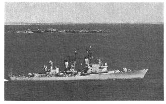
Raketenzerstörer, wie hier die «USS Luce» (DLG-7) gehören zu den Begleiteinheiten der Flugzeugträger. Dieses Schiff der «Coontz»-Klasse (10 Schiffe) verdrängt 4770 Tonnen, läuft über 60 km/h und verfügt über starke Flabartillerie (inkl. eines «Terrier»-Doppelstarters) und ist für den Abschuss von Torpedos mit Raketentriebsätzen eingerichtet.
