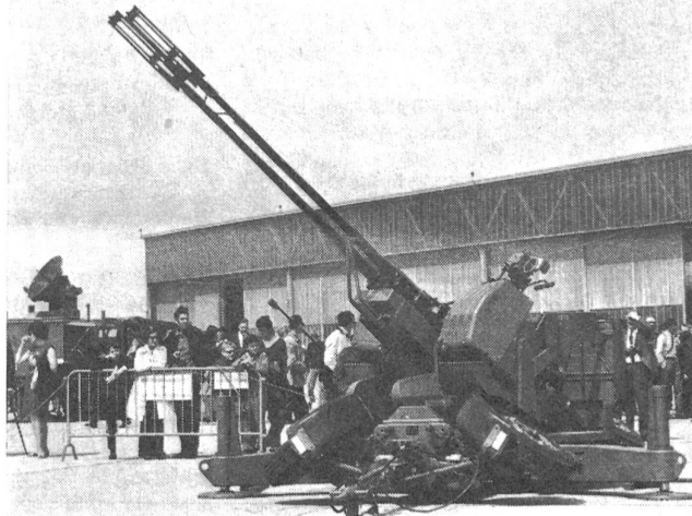
Im Freigelände vor der Flughalle war das Material der Flabtruppen zu besichtigen, wie diese Flab-Kanonen 35 mm. Im Hintergrund der «Fledermaus»-Radar.
