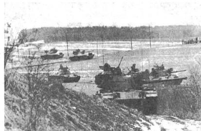
Panzer des Typs M-60 bei einer Übung auf dem Truppenübungsplatz Grafenwöhr. Über der 10,5-cm-Kanone ist der Infrarotscheinwerfer erkennbar, auf dem Turm das voll gepanzerte 12,7-mm-Mg.
