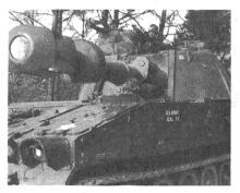
Die Hauptstütze der amerikanischen Artillerie ist die Panzerhaubitze M-109 (Kaliber 15,5 cm, 24 t schwer), die ab 1971 in die Hb-Regimenter der Mech Div der Schweizer Armee eingeführt wird. Die abgebildete Haubitze gehört zur Charlie-Batterie, 2. Artilleriebataillon, 14. Artillerieregiment, 4. Panzerdivision.
