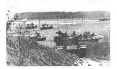
Panzer des Typs M-60 bei einer Übung auf dem Truppenübungsplatz Grafenwöhr. Über der 10,5-cm-Kanone ist der Infrarotscheinwerfer erkenntlich, auf dem Turm das voll gepanzerte 12,7-mm-Ma.
