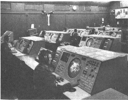
In der «Florida»-Einsatzzentrale werden alle Informationen auf den Bildschirmgeräten dargestellt, um den Verantwortlichen die Einleitung von Abwehrmaßnahmen zu ermöglichen. Von hier aus erfolgt die Warnung von Zivilbevölkerung und Armee, der Einsatz von Luftverteidigungsmitteln sowie die Führung der Flieger- und Fliegerabwehrtruppen im allgemeinen.
