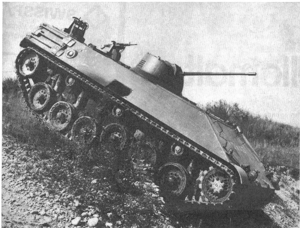
Der moderne Kampfschützenpanzer TORNADO besitzt mit seinen 8 Feuerständen eine sehr hohe Feuerkraft. Die 12 Mann Besatzung kämpfen aufgesessen und aus dem völlig geschlossenen Wagen. Das aussergewöhnlich bewegliche Fahrzeug ist für Operationen im ABC-verseuchten Gelände geeignet.
