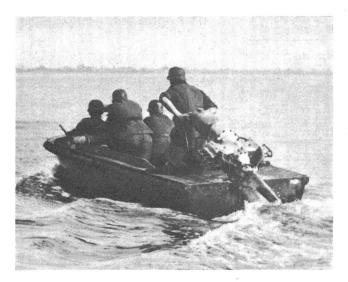
Deutsches Sturmboot. Aus Holz gebaut. Sehr geringer Tiefgang (unbelastet schwimmt das Boot schon bei 10 cm Wasser). 4-Zylinder-Aussenbordmotor. Geschwindigkeit 30 km/h. Besatzung: 2 Mann (ein Bootsführer im Heck, ein Gehilfe im Bug). Fassungsvermögen: Zusätzlich zur Besatzung noch 6 Infanteristen.
