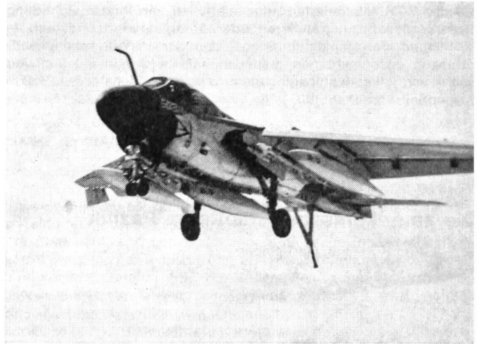
Mit leeren Bombenrecks kehrt ein Intruder-Bomber von seinem Einsatz zurück. Die Bremsklappen und der ausgefahrene Fanghaken sind gut erkennbar.
