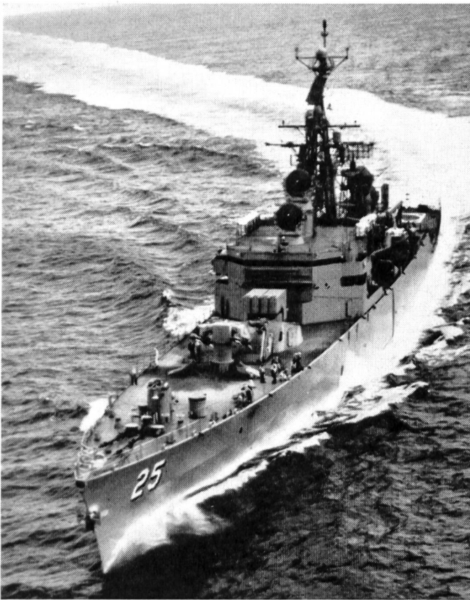
Die atomgetriebene Raketenfregatte «USS Bainbridge» gehört zum «Beschützerteam» der «Enterprise» und verfügt ausser 4 \times 7,6 -cm-Geschützen nur über Raketenwaffen und U-Boot-Abwehrmittel (2 ferngesteuerte torpedotragende Helikopter). Ausserdem verfügt das Schiff über 6 Torpedorohre.
