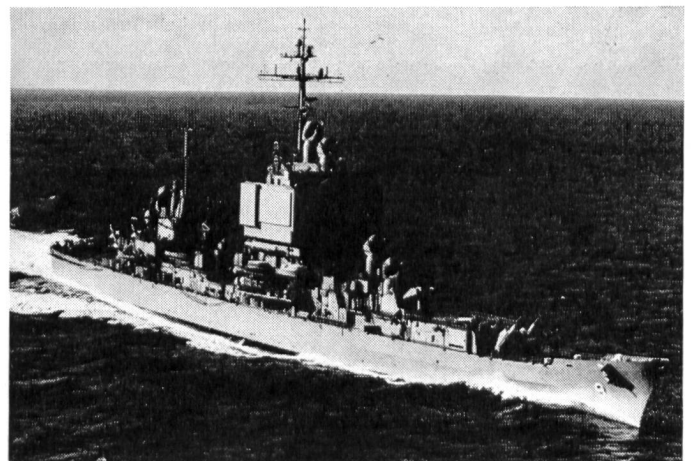
Als dritte Einheit zählt der Atomraketenkreuzer «USS Long Beach» zu diesem Atomverband. Vorerst besass er überhaupt keine Rohrmaschinen, sondern nur Raketenwerfer für «Talos»- und «Terrier»-Raketen sowie Anti-U-Boot-Raketen. Später wurden dem Schiff zusätzlich zwei 12,7-cm-Geschütze eingebaut. Der Kreuzer verfügt auf dem Heck über ein Helikopterdeck. Eine vierte Atomüberwassereinheit, die Raketenfregatte «USS Truxtun», operiert gelegentlich mit diesem Verband.
