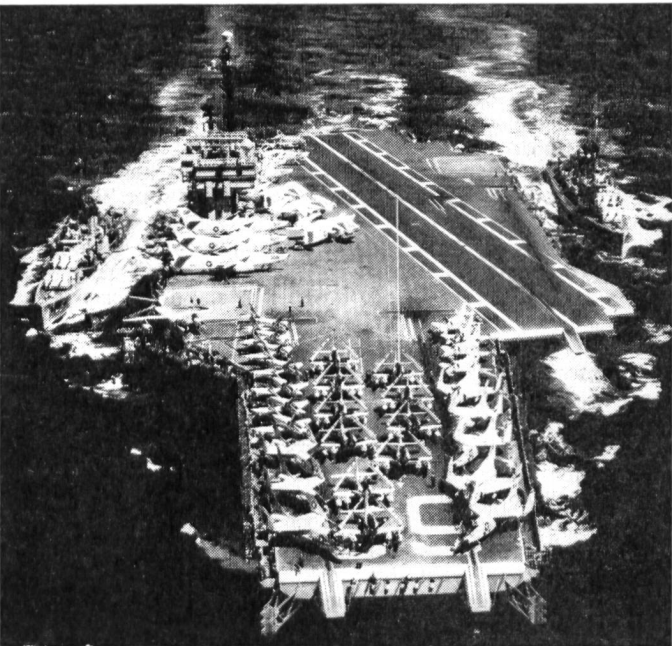
Hier betätigt sich der 79 000 t grosse Flugzeugträger «USS Kitty Hawk» als Versorger, indem er gleichzeitig an die Zerstörer «McKean» und «Hubbard» Brennstoff abgibt. Auf dem Vorderdeck sind noch Skyraider-Propellerflugzeuge (jetzt ausser Dienst) sichtbar.
