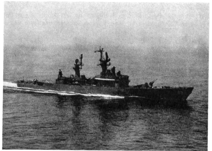
Die Raketenfregatte «USS Wainwright» dient wie ihre Schwesterschiffe vor allem der U-Boot-Jagd und dem Schutz von Trägerverbänden gegen fremde Flugzeuge. Die Rohrartillerie ist nur durch den 12,7-cm-Heckturm vertreten, während vorne Terrier-Flakraketen installiert sind; dazu gehören ferner ein U-Boot-Abwehr-Helikopter, 2 × 7,6-cm-Flakkanonen und ein Anti-U-Boot-Raketenwerfer (Raketen mit zielsuchenden Torpedoköpfen).
