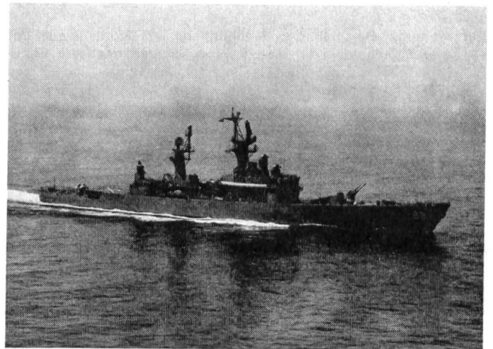
Die Raketenfregatte «USS Wainwright» dient wie ihre Schwesterschiffe vor allem der U-Boot-Jagd und dem Schutz von Trägerverbänden gegen fremde Flugzeuge. Die Rohrartillerie ist nur durch den 12,7-cm-Heckturm vertreten, während vorne Terrier-Flakraketen installiert sind; dazu gehören ferner ein U-Boot-Abwehr-Helikopter, 2 \times 7,6-cm-Flakkanonen und ein Anti-U-Boot-Raketenwerfer (Raketen mit zielsuchenden Torpedoköpfen).
