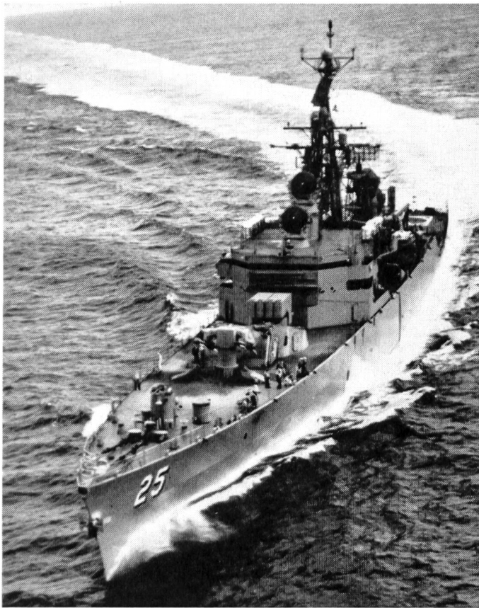
Die atomgetriebene Raketenfregatte «USS Bainbridge» gehört zum «Beschützerteam» der «Enterprise» und verfügt ausser 4 × 7,6-cm-Geschützen nur über Raketenwaffen und U-Boot-Abwehrmittel (2 ferngesteuerte torpedotragende Helikopter). Ausserdem verfügt das Schiff über 6 Torpedorohre.
