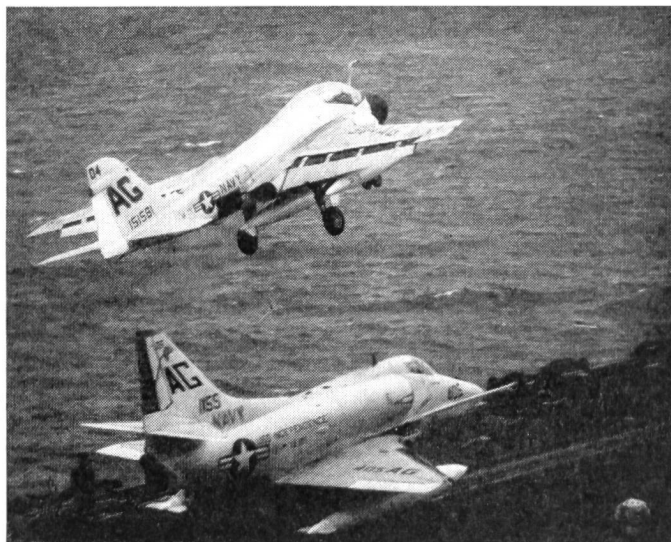
Startoperationen. Mit Bomben und Zusatztanks beladen, werden die Trägermaschinen von den Katapulten in die Luft geschleudert. Hier hat ein A-6 Intruder soeben das Deck verlassen, während ein A-4 C Skyhawk auf einem anderen (der insgesamt vier) Katapult auf den «Abschuss» wartet.
