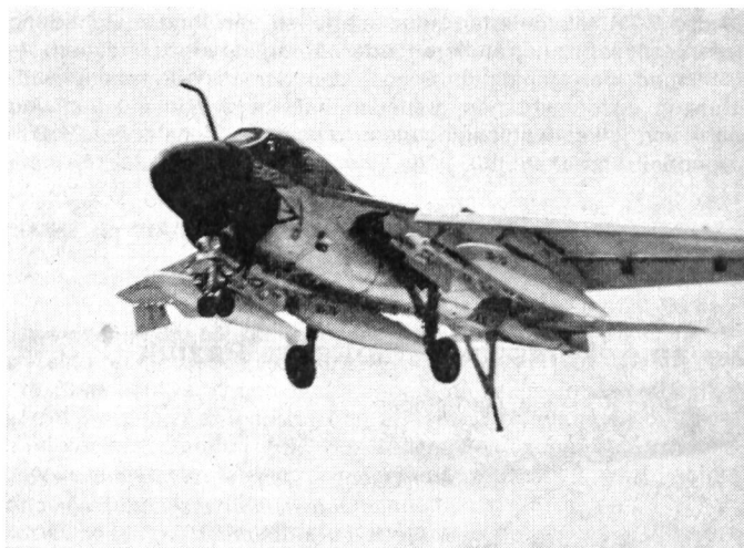
Mit leeren Bombenrecks kehrt ein Intruder-Bomber von seinem Einsatz zurück. Die Bremsklappen und der ausgefahrene Fanghaken sind gut erkennbar
