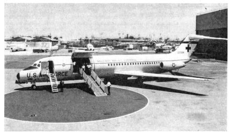
Die C-9 A mit der grossen Ladepforte im Vorderrumpf. Über die hydraulisch betätigte Rampe können Patienten auf Bahren oder in Rollstühlen leicht transportiert werden.
