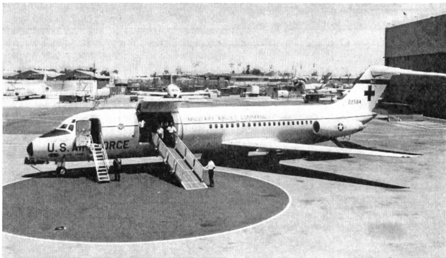
Die C-9 A mit der grossen Ladeporte im Vorderrumpf. Über die hydraulisch betätigte Rampe können Patienten auf Bahren oder in Rollstühlen leicht transportiert werden.
