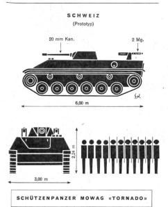
Baujahr 1968 Motor (Diesel) 430 PS Gewicht 20 t Max. Geschw, 70 km/h
