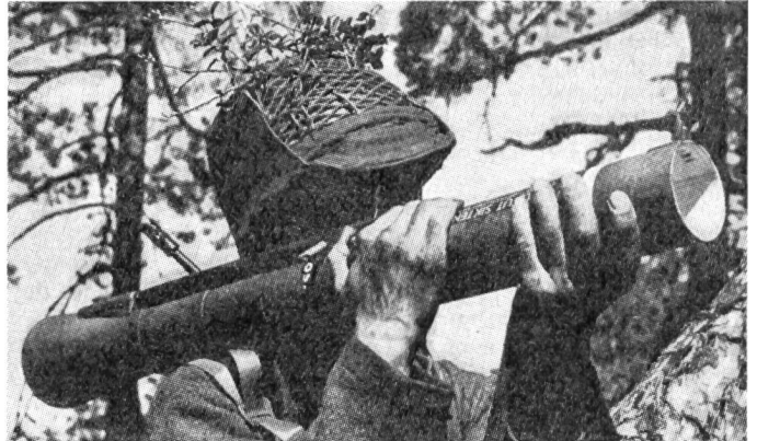
Das ist die neue Panzerabwehrwaffe «Miniman» der schwedischen Armee. Das Abschussrohr, geladen mit einer Hohlladungsgranate, wiegt total 2,6 kg und wird nach dem Schuss fortgeworfen.
