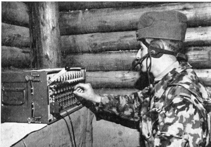
Über die Feldtelefonzentrale werden die einzelnen Kampfgruppenkommandanten miteinander verbunden. Das Telefonnetz bildet das Basisnetz im Infanterieregiment.
