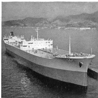
Der 69000-Tonnen-Motortanker «Ise Maru» wird von einem Ishikawajima-Harima-Sulzer-Zweitakt Dieselmotor, Typ 9 RD 90, angetrieben. Dieser neunzylindrige Hauptmotor von 900 mm Bohrung, 1550 mm Hub und 19800 PS Dauerleistung bei 119 U/min verleiht dem Tanker eine Geschwindigkeit von 15,5 Knoten.
