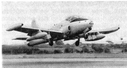
Das Trainingsflugzeug BAC 167 mit einer typischen Erdkampfausrüstung: 16 Raketen und zwei Zusatztanks
