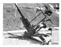
Die Fernsehkamera dient der Kontrolle der 20-mm-Flab-Kanoniere beim Richten ihres Geschützes auf das angreifende Flugzeug.
