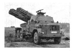
Der Raketenwerfer, mehrfach, leicht, ist eine Flächenfeuerwaffe der Artillerie. Mit der Einführung in das Heer wird die Feuerkraft der Artillerie erheblich gesteigert.
