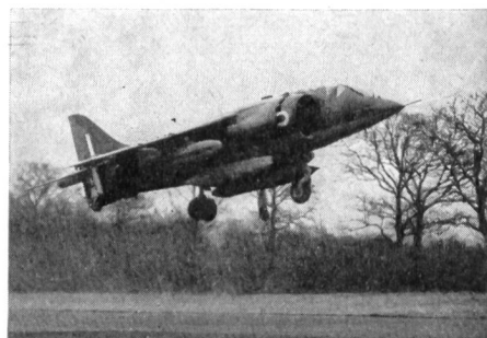
Es ist zum Senkrecht-in-die-Lüfte-Gehen — mit dem Harrier. Dieser erste truppenreife Senkrechtstarter der westlichen Welt ist zum Einsatz auf vorgeschobenen Behelfs-flugplätzen konzipiert. Er tritt 1969 in den Staffeldienst bei der Royal Air Force und ist als Ersatz der Hunter gedacht.
