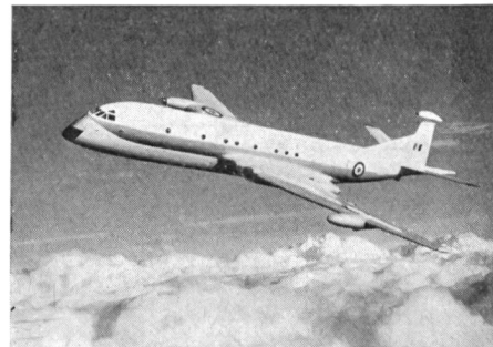
Vom Verkehrsflugzeug zum Seeaufklärer. Die vierstrahlige HS.801 Nimrod wurde aus der Comet 4 abgeleitet. Mit 4 ökonomischen Triebwerken Spey ausgerüstet, kann die HS.801 bis zu 14 Stunden über dem Meer patrouillieren. Die modernen elektronischen Detektionsgeräte an Bord werden von einer 11köpfigen Besatzung (inklusive der Piloten) bedient.
