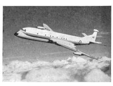
Vom Verkehrsflugzeug zum Seeaufklärer. Die vierstrahlige HS.801 Nimrod wurde aus der Comet 4 abgeleitet. Mit 4 ökonomischen Triebwerken Spey ausgerüstet, kann die HS.801 bis zu 14 Stunden über dem Meer patrouillieren. Die modernen elektronischen Detektionsgeräte an Bord werden von einer 11köpfigen Besatzung (inklusive der Piloten) bedient.
