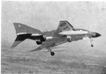
Die neueste Errungenschaft der Royal Navy: die F-4 K Phantom. Dieser Allwetter-Jäger wird in den kommenden Jahren allmählich die Sea Vixen ablösen. Die Phantom kann Waffen konventioneller Art sowie Lenk Waffen vom Typ Martel und Sparrow mitführen. Die Spitzengeschwindigkeit der F-4 K liegt bei 2200 km/h (Mach 2,1). Unser Bild zeigt eine Maschine mit zwei Zusatz-tanks unter den Tragflächen.
