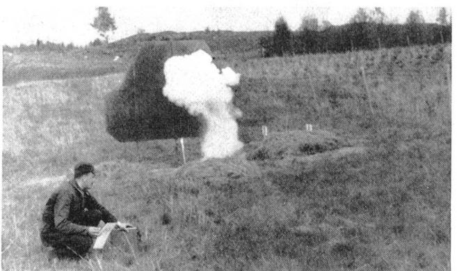
In Zusammenarbeit mit der Armee hat die bekannte Firma SAAB in Linköping ein ganzes System von Scheiben entwickelt, mit denen feindliche Truppen in verschiedenen Stellungen simuliert werden können, ergänzt durch ferngesteuerte Simulierung von Kampfhandlungen. Diese Panzerscheibe gibt durch ein Lichtsignal Kenntnis von einem Treffer. Die Scheibe kann zudem mit einem Rauchanziger verbunden werden, der einen schwarzen oder roten Rauchpilz bildet, der sehr gut beobachtet werden kann.
