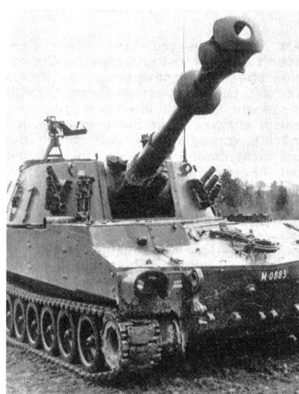
Die M-109 Panzerhaubitze mit hochgefahrenem Rohr. Auffallend sind die Mündungsbremse und der mächtige Rauchabzug. Links und rechts am Turm sind je drei Nebelwerfer sichtbar.
