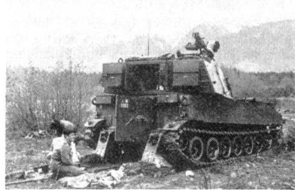
Die M-109 in Schußposition mit gesenkten Klappen, auf die die Haubitze aufgefahren ist. Ein Teil der 6-köpfigen Geschützbedienung (zusätzlich Fahrer und Kpl) bereitet außerhalb des Geschützes die Granaten vor (Ladung, Zünderart, Tempierung). Im Hintergrund das Gantischgebiet.
