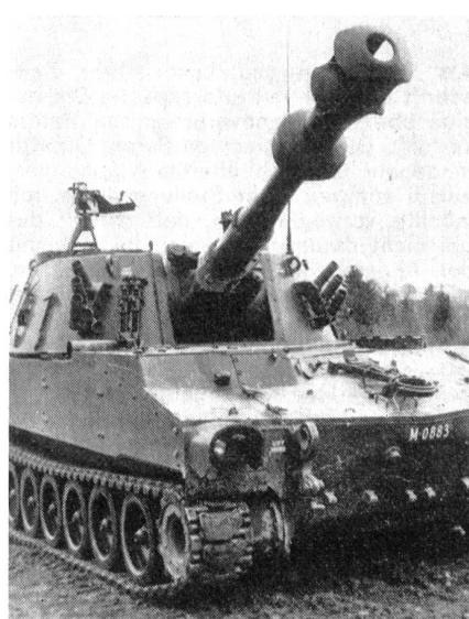
Die M-109 Panzerhaubitze mit hochgefahrenem Rohr. Auffallend sind die Mündungsbremse und der mächtige Rauchabzug. Links und rechts am Turm sind je drei Nebelwerfer sichtbar.
