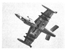
Weiterentwicklung des früheren P-16, der vor neun Jahren vom EMD während der fortgeschrittenen Flugerprobung plötzlich abbestellt worden war. Der AA-7 ist mit einem Atar 9-Triebwerk,
