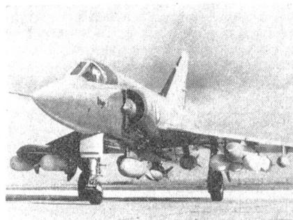
Aus der Mirage III haben die französischen Dassault-Werke ein ebenfalls polyvalentes Kampfflugzeug, die Mirage 5, entwickelt. Die äußeren Abmessungen der Mirage 5 sind grundsätzlich dieselben wie die des Basismusters, ebenso ist die Mirage 5 mit dem gleichen Triebwerk ausgerüstet.
