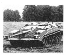
Schwedens neuer Panzer «S» gilt als der zur Zeit modernste der ganzen Welt. Er verfügt über ein Gesamtgewicht von 37 Tonnen; seine Länge mit Kanone und äußerer Ausrüstung beträgt 8,8 m, die Gesamtbreite 3,3 m.
