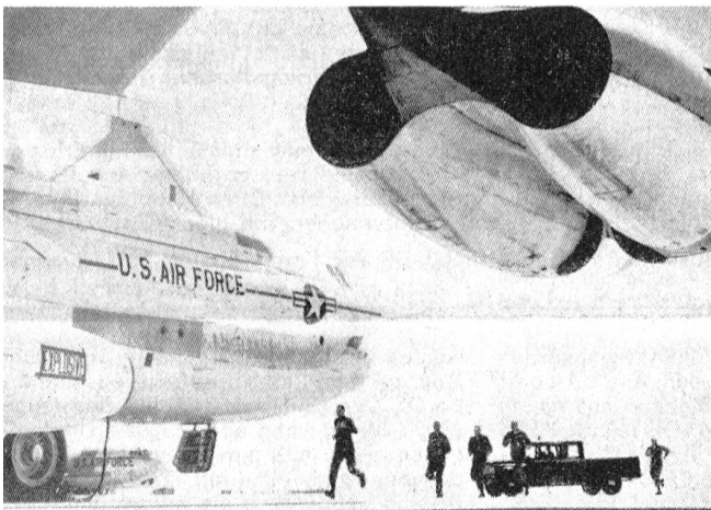
Nach einem Alarm wurde die Besatzung per Auto zum Bomber gebracht, den sie nun bemannt. Im Vordergrund ist eine Hound-Dog-Luft-Boden-Fernlenkwafe sichtbar. Der Bomber kann diese Wafe schon 500 Meilen vom Ziel entfernt zünden.
