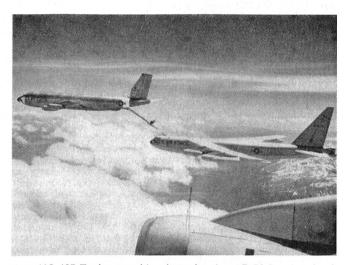
Eine KC-135-Tankermaschine betankt einen B-52-Bomber hoch über den Wolken. Die KC-135 ist eine SAC-Version der zivilen Boeing 707.
