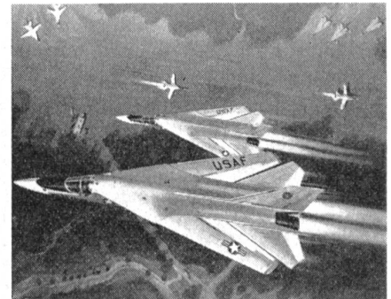
Zwei F-111-Typen im Fluge mit maximal gepfeilten Tragflügeln für den Hochgeschwindigkeitsflug (Pfeilflügelstellung ca. 72 Grad).
