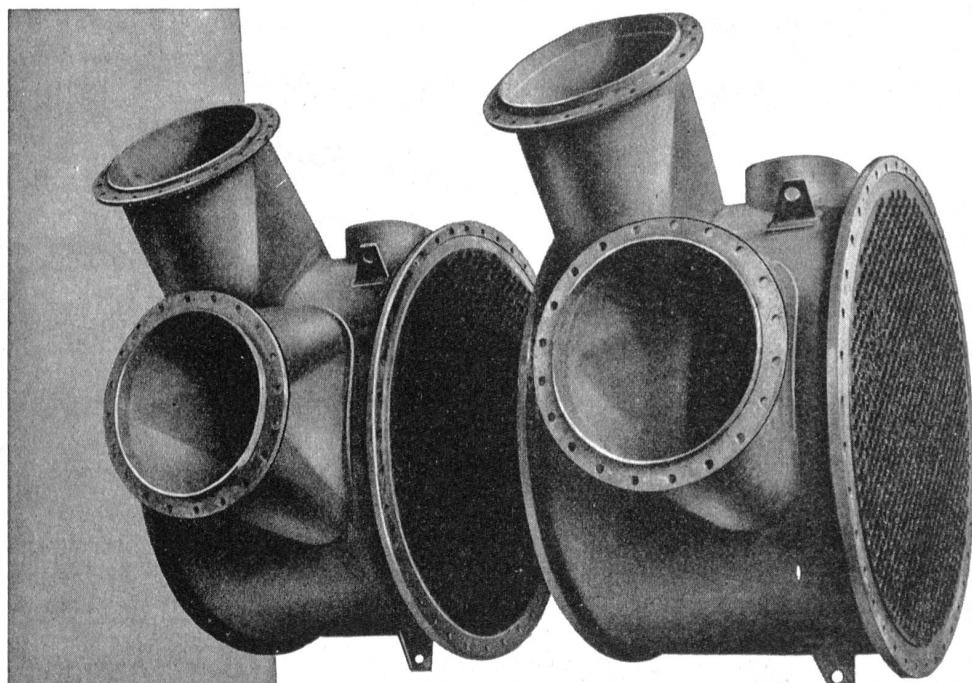
Solche Wärmeaus-tauscher — ein Bei-spiel aus unserer leistungsfähigen Werkstätte — sind in einer Fabrik der Chemischen Industrie montiert worden. 847 eingewalzte Stahl-rohre ergeben 115 m<sup>2</sup> Heizfläche, und das Gewicht beträgt 5 t pro Apparat.
