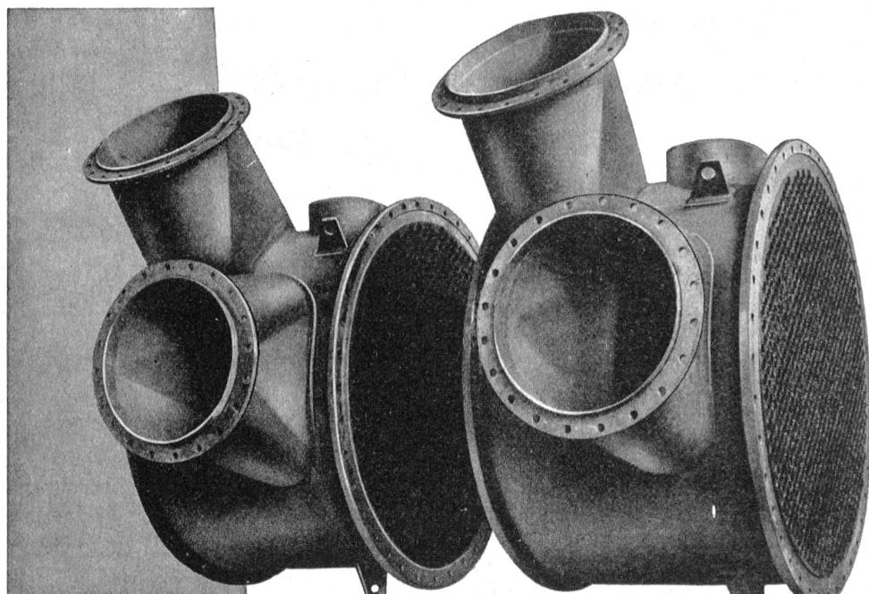
Solche Wärmeaus-tauscher — ein Bei-spiel aus unserer leistungsfähigen Werkstätte — sind in einer Fabrik der Chemischen Industrie montiert worden. 847 eingewalzte Stahl-rohre ergeben 115 m<sup>2</sup> Heizfläche, und das Gewicht beträgt 5 t pro Apparat.
