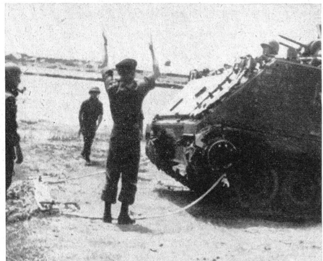
Vorne am Antriebsrad bemerkt man die Trommel und das Seil, welches mit dem Anker verbunden ist. Mit diesem System kann sich der Spz leicht aus dem Schlamm befreien.
