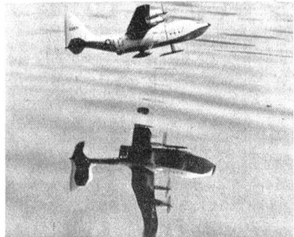
Neue Aufgaben für die bewährte Lockheed C-130 Hercules: Sie wird möglicherweise noch als Wasserflugzeug zum Einsatz kommen. Unser Bild zeigt ein Modell der projektierten C-130 HOW.
