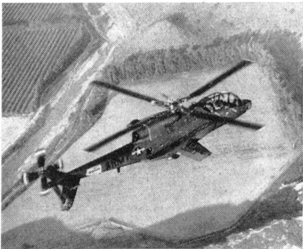
Das Schlachtroß der siebziger Jahre für die Kampfzone: Die AH-56A Cheyenne mit dem starren Rotor und den Stummelflügeln auf beiden Seiten des Rumpfes.
