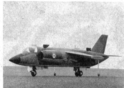
Modell des von Fiat in Zusammenarbeit mit VFW zu bauende VTOL-Kampfflugzeuges VAK 191 B. Auf dem Bild sind die Luken der Hubtriebwerke geöffnet.
