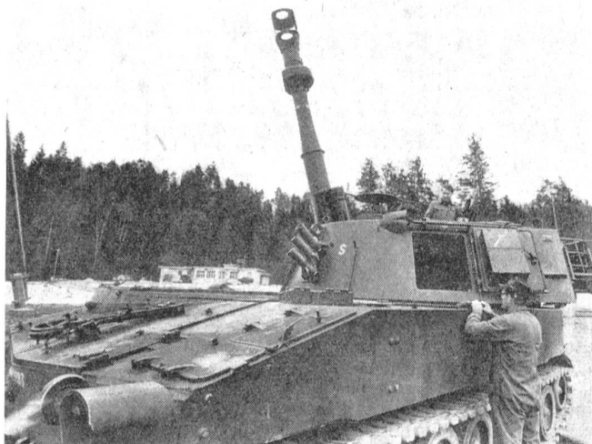
Die Panzerhaubitze M-109, mit welcher die Schlagkraft unserer Armee stark erhöht werden kann. Deutlich sind die groß dimensionierte Mündungsbremse und der Rauchabzug zu erkennen.
