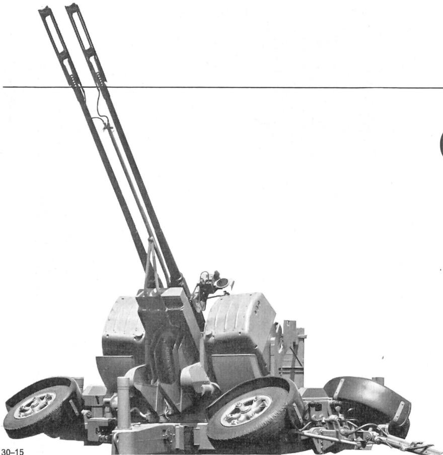
35 mm Zwillings-Fliegerabwehr-geschütz ausgerüstet mit einer Oerlikon  $v_0$ -Messeinrichtung.
