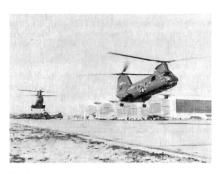
Bei einem Versorgungsdienst für einen Flugzeugträger befördern die «Sea Knights» 200 bis 300 vorgepackte Lasten von je 1575 kg Gewicht, die auf dem rückwärtigen Flugdeck laufend gestapelt werden und von den Helikoptern mit je einer Minute Abstand aufgenommen und zu dem übernehmenden Schiff geflogen werden.
