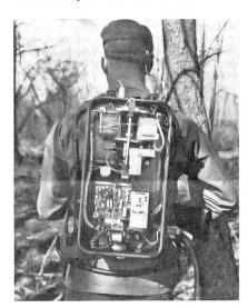
Der geöffnete Apparat zeigt die einzelnen Funktionseinheiten des Aufspürers. Die Luft wird eingesaugt und elektronisch auf submikroskopische Bestandteile untersucht, die von menschlichen Körpern abgegeben worden sind. Das Warnsignal verstärkt sich entsprechend der Anzahl der aufgespürten Leute. (Beachten Sie bitte auch unser Umschlagbild)
