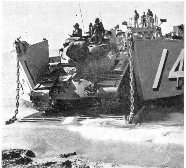
Die Landungen der Marinefüsilier in Südsardinien wurden auch von schweren Waffen unterstützt. Hier rollt ein M48A1-Panzer der Marines von Bord eines Panzerlandungsschiffes des riesigen Landungsdockschiffes USS CASA GRANDE (LSD-13), das weit draußen vor Anker liegt. Der große Behälter über dem Geschütz des M48A1 Panzers ist nichts anderes als ein Nachtzielgerät für die Kanone.
