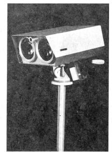
Mit diesem von Grundig gebauten Lichtsprechgerät LiG 3, montiert auf einem Stativ, und gleicher Gegenstation läßt sich ein einwandfreier Sprechverkehr bis zu 2 Kilometern herstellen. Es eignet sich auch für militärische Zwecke.
