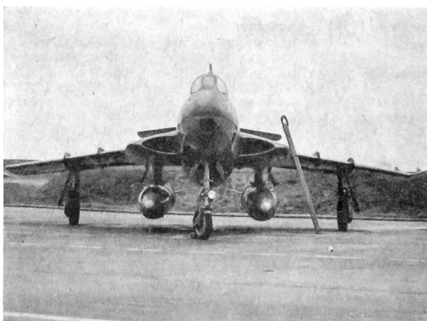
Republic RF-84 F Thunderflash Bitte beachten: Der Lufteinlaß ist beim Aufklärungsflugzeug des Typs F-84 an die Flügelwurzeln verlegt, da die Rumpfspitze für andere Zwecke verwendet wurde. Beim Jagdbomber befindet sich der Lufteinlaß in der Rumpfspitze.
