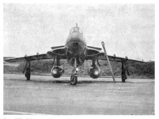
Republik RF-84 F Thunderflash Bitte beachten: Der Lufteinlaß ist beim Aufklärungsflugzeug des Typs F-84 an die Flügelwurzeln verlegt, da die Rumpfspitze für andere Zwecke verwendet wurde. Beim Jagdbomber befindet sich der Lufteinlaß in der Rumpfspitze.
