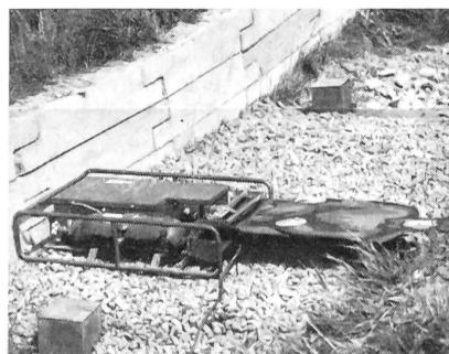
Aus der Nähe betrachtet, sieht die Klappzielscheibe etwas kompliziert aus, ist es aber nicht. Das Auf- und Abklappen wird mit Hilfe von Druckluft durchgeführt. Die Treffer in der Zielscheibe werden durch einen elektrischen Geber, welcher an ihrer Unterkante befestigt wird, abgenommen.
