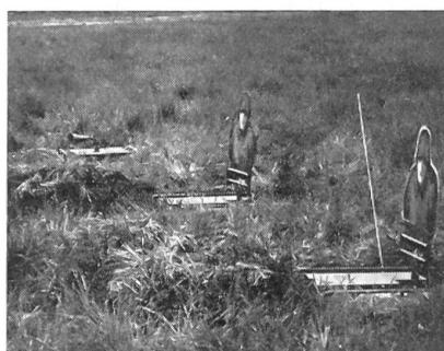
Die Zielscheibe ist ein Gerät, das bei einem Treffer automatisch umfällt. Sie kann durch automatische Fernsteuerung wieder zum Stehen gebracht werden. Die Zielanlage kann bei Fernsteuerung mit einem Maschinengewehrfeuer-Simulator (links) gekoppelt werden.
