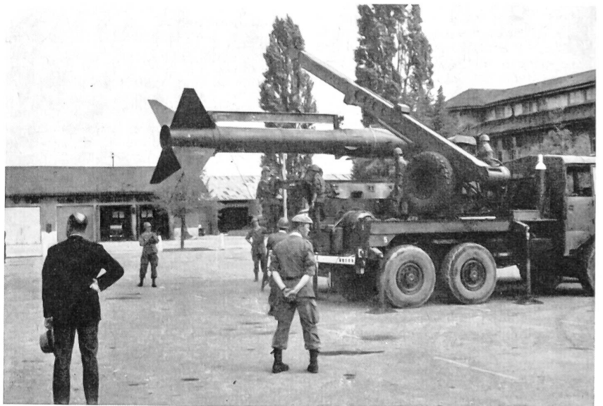
Eine montierte Rakete wird vom Kranwagen auf den Abschuwagen befördert.
