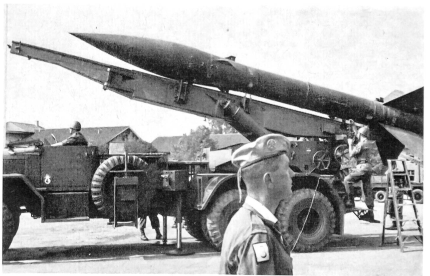
Der Abschlußwagen ist in Stellung, und nun wird die Rakete in den berechneten Abschlußwinkel gebracht.
