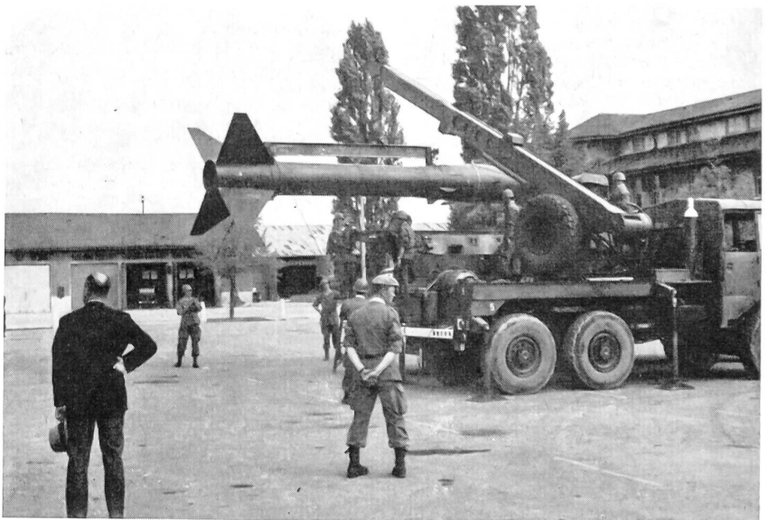
Eine montierte Rakete wird vom Kranwagen auf den Abschluß-Lastwagen befördert.
