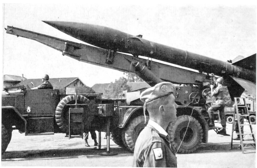
Der Abschlußwagen ist in Stellung, und nun wird die Rakete in den berechneten Abschlußwinkel gebracht.
