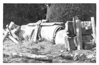
Uebungsstation «Fuchsröhre». Sie dient der Anwendung der Geräte und Werkzeuge in stark beengten Verhältnissen. Die Hindernisse zwischen den Rohrstücken sind auswechselbar.
