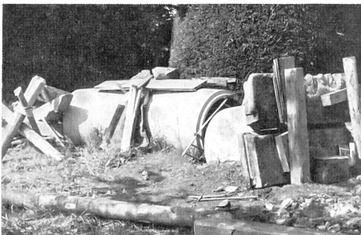
Übungsstation «Fuchsröhre». Sie dient der Anwendung der Geräte und Werkzeuge in stark beengten Verhältnissen. Die Hindernisse zwischen den Rohrstücken sind auswechselbar.
