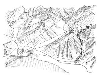
Während der Verschiebung des Kommandanten auf der Achse A--D erfolgt die Funkverbindung zu B über das Relais 2, während zu C sowohl das Relais 2 als auch das Relais 1 als Kettenstrecke benützt wird.
