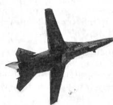
Die amerikanische Hauptattraktion in Le Bourget bildete das erstmals in Europa gezeigte Kampf- und Aufklärungsflugzeug F-111. Diese mit Tragflächen variabler Pfeilung ausgerüstete Maschine steht gegenwärtig in Produktion für die US Air Force und US Navy. Die Höchstgeschwindigkeit der F-111 liegt bei 2650 km/h (Mach 2,5).
