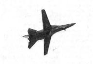
Altbekannt und doch immer wieder faszinierend: die F-4B «Phantom II». Unser Bild zeigt eine Maschine im Tiefflug vor den Zuschauern vorbeibrausend. Die beiden General Electric J79-Triebwerke entwickeln je einen Gesamtschub von 7710 kp und verleihen der «Phantom II» eine Spitzengeschwindigkeit von 2550 km/h (Mach 2,4).
