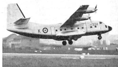
Ein großer Wurf der französischen Breguet-Werke: der Kampfzonen-Transporter Breguet 941 S. Bei einem Startgewicht von 20 Tonnen hebt die Maschine nach einer Rollstrecke von nur 150 Metern(!) vom Boden ab. Die französische Luftwaffe hat bereits eine Anzahl dieser Maschinen in Auftrag gegeben.
