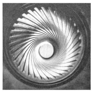
Der Blick in ein Kanonenrohr zeigt die schraubenförmig gewundenen Züge, die dem Geschoß eine rasche Drehung um seine Längsachse aufzwingen. Diese Bewegung nennt man «Drall». Er erst machte die Verwendung von Langgeschossen möglich, weil er das Ueberschlagen verhindert und dem Geschoß zu einem ruhigen, stabilisierten Flug verhilft.
