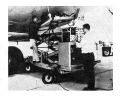
Das neuartige Ultraschallgerät kann die Wandung eines Flugzeugtanks von der Außenseite der Tragfläche her auf Korrosionsstellen inspizieren ohne Ablassen des Treibstoffs und Reinigen des Tanks im Innern.
