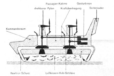
Prinzipschema eines Luftkissenfahrzeuges
